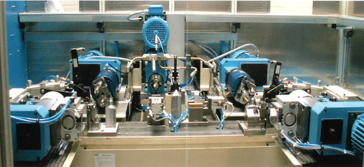
Bohren und planfräsen an einem Aluminium-Gießteil
