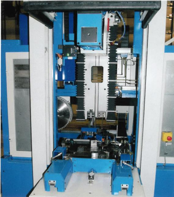
Anguss sägen und bohren am Teil in einem Arbeitsgang
